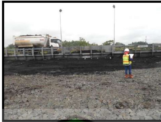
Gambar 4.16. Hauler Melakukan Proses Dumping di Dump Hopper IV Feeder 2
